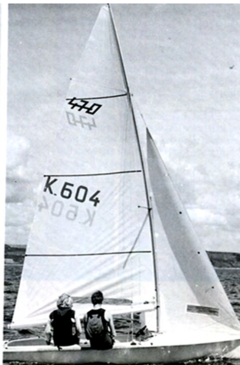
Joonis 7.37 Masti ja purjede asend nõrgas tuules tagantvaates
